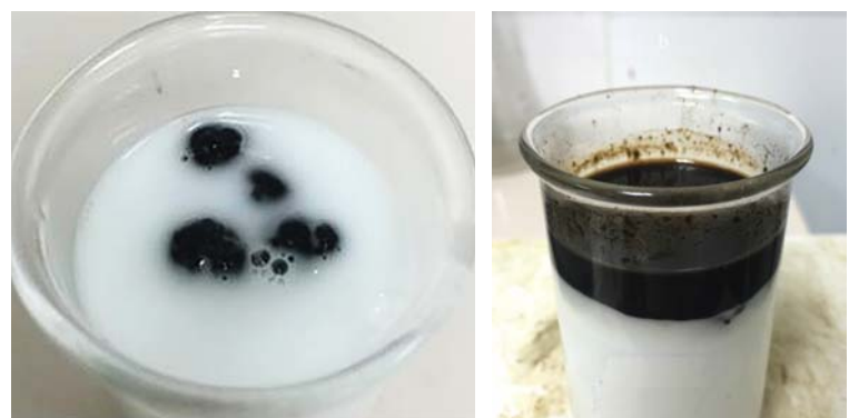
Hình 12. Hệ chất tẩy cặn dầu thô VPI-WR hòa tan cặn dầu thô ở nhiệt độ phòng có tỷ lệ VPI-WR/nước là 40/60
