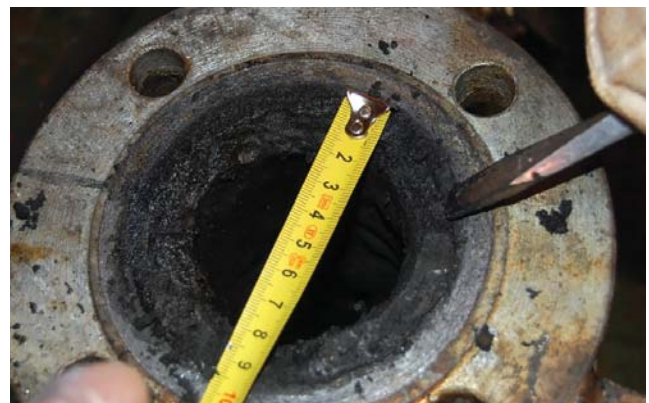
Lắng đọng trong ống dẫn sau hệ thống Hydrocyclon của giàn công nghệ CPP-3
