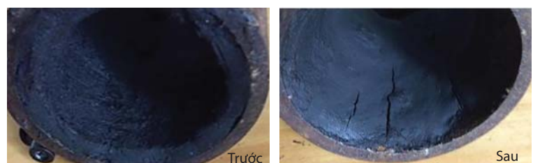
Hình 13. Hình ảnh đoạn ống trước và sau khi tẩy cặn dầu thô bằng VPI-WR
