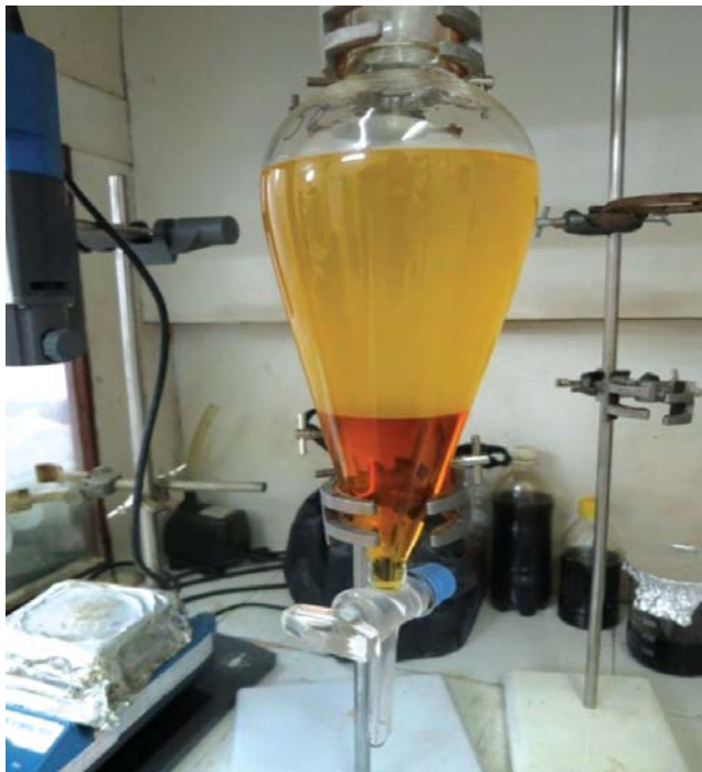
Hình 9. Sản phẩm thu được sau phản ứng transester hóa có sự phân tách pha: pha ester ở trên và pha glycerol ở dưới
