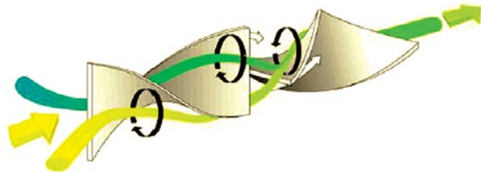
Hình 2. Chuyển hướng của dòng chảy khí qua thiết bị static mixer với vật chêm dạng cánh xoắn
