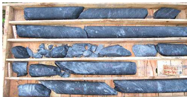
Hình 9. Tập sét gốc màu đen thuộc hệ tầng Văn Lãng (T 3n-r vl) gập ở lỗ khoan LK45 thuộc địa phận Văn Sơn - Sơn Động - Bắc Giang. Góc dốc đo được khoảng 45°
