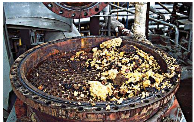
Hình 1. Cặn bẩn polymer lắng đọng trên bề mặt đĩa tháp chưng cất
