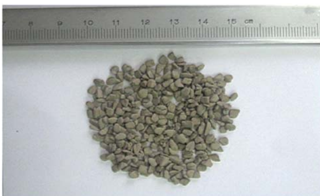
Hình 8. Mẫu mùn khoan thu hồi của dung dịch KLATROL
