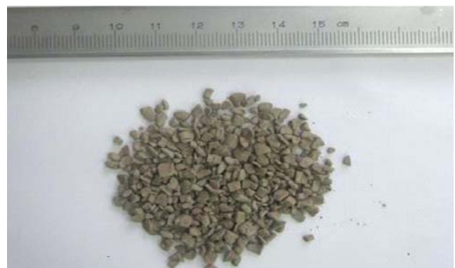
Hình 9. Mẫu mùn khoan thu hồi của dung dịch Ultradril
