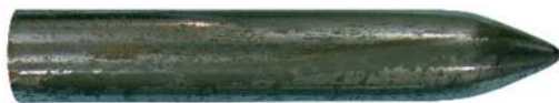
E10 + Nước cất không phụ gia Ăn mòn thép trong hỗn hợp (E10 + nước cất)
