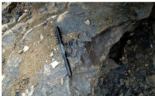
Hình 7. Đá vôi chứa asphalt và những thấu kính asphalt bị phong hóa tại bản Nậm Ún - 2 [21]
