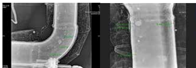
Hình 9. Hình ảnh chụp X quang kỹ thuật số đường ống xuyên qua lớp bọc bảo ôn [4]
