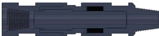
Hình 5. Cấu tạo cơ bản của thiết bị giảm sóc
