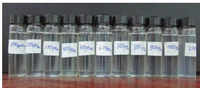
Hình 7. Khả năng phân tán dung dịch keo nanosilica trong hệ chất hoạt động bề mặt sau 28 ngày
