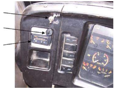
Hình 10. Ảnh chụp thực tế vị trí ECU và công tắc LPG khoang lái trên xe
