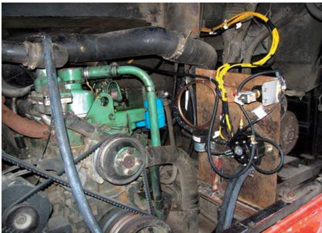
Hình 8. Các bộ phận cấp LPG cho xe khách Transinco
