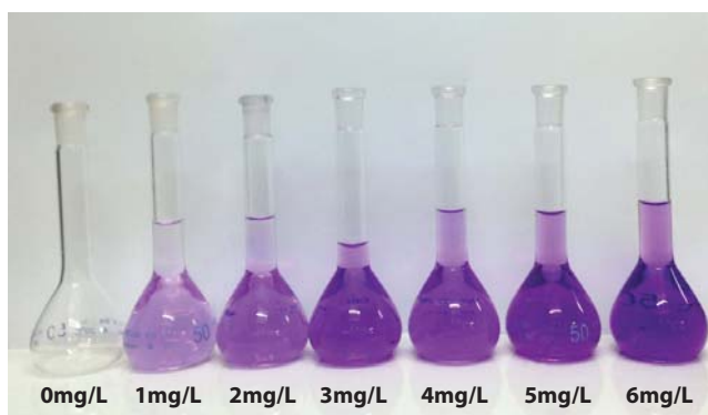
Hình 4. Dãy dung dịch chuẩn có nồng độ I - tăng dần từ 0 - 6mg/L lập tại Phòng thí nghiệm địa hóa - Viện Dầu khí Việt Nam
