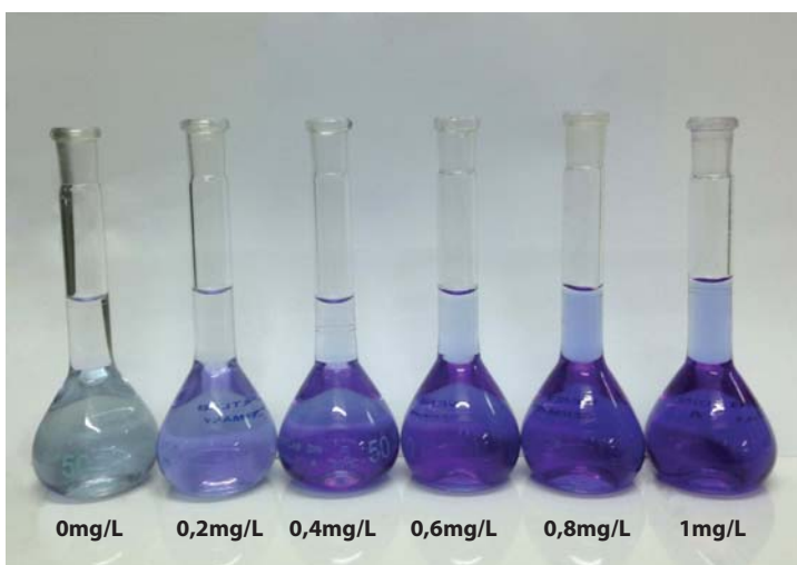
Hình 2. Dãy dung dịch chuẩn có nồng độ Br- tăng dần từ 0 - 1mg/L lập tại Phòng thí nghiệm địa hóa - Viện Dầu khí Việt Nam
