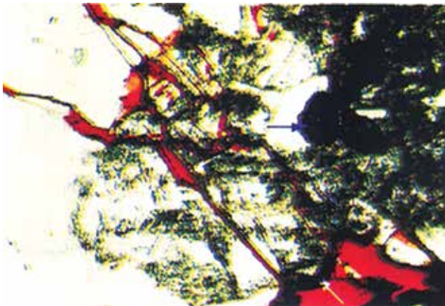
Hình 2. Granite nứt nẻ và hang hốc, lấp đầy các khoáng vật thứ sinh. Nguồn: Vietsovpetro
